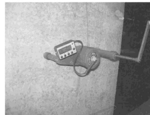
Рис. 1 Определение прочности бетона методом отрыва со скалыванием.
